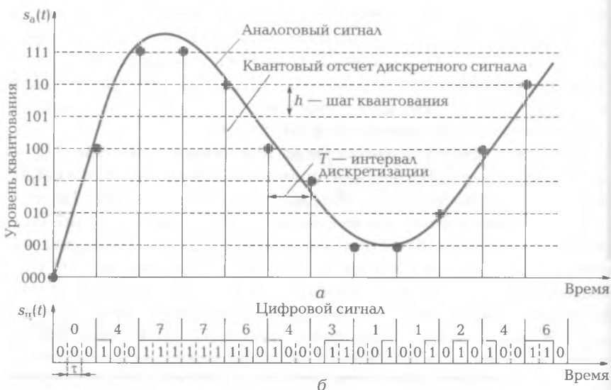
Рис. 3.3. Дискретизация аналогового сигнала (а) и его цифровой эквивалент (б)
