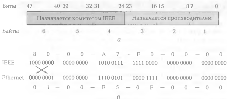
Рис. 4.5. Формат MAC-адреса сети Ethernet (а) и порядок расположения битов в байте (б)
