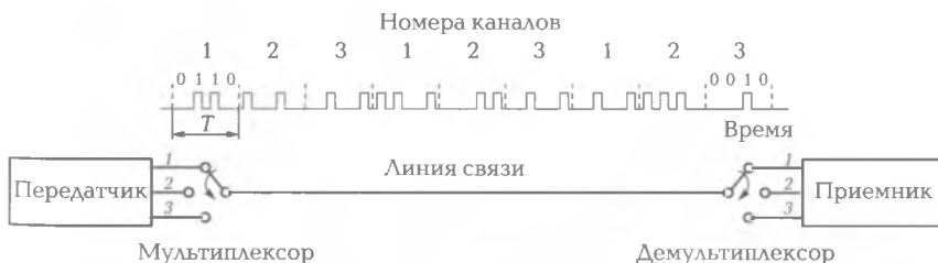
Рис. 3.7. Принцип временного разделения каналов
